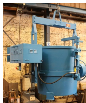
Cuchara ZH de Colada por Buza, Equipada con Ropastop Bottom Pour Side System Operado Remotamente
