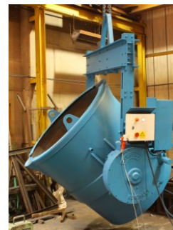
Cuchara ZH de Colada por el Pico Equipada con Reductor Motorizado Roperlok Operado Remotamente
