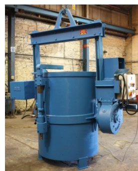
Cuchara ZH de Colada por Buza , Equipada con Ropastop Bottom Pour Side System y Reductor Motorizado Roperlok Operada Totalmente por Control Remoto
